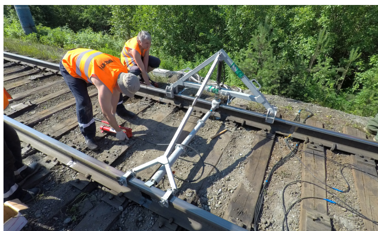
Рис. 4. Установка устройства разработки ООО «ТИЦ ЖТ» для определения масштабов измерения по методу измерения боковой и вертикальной силы «РЖД-2016»
