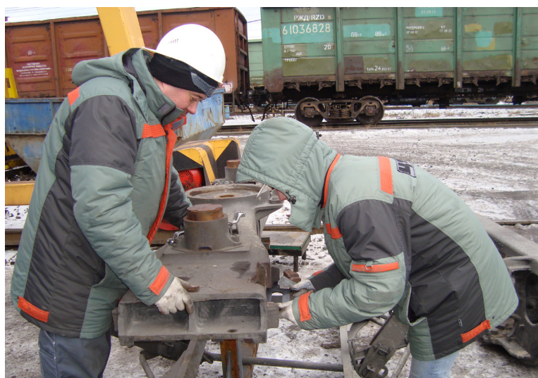
Рис. 9. Проведение обмеров износов карманов надрессорных балок специалистами ООО «ВНИЦТТ»
