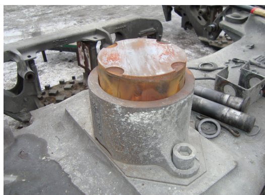
Корпус и колпак бокового скользунa (на колпаке видны индикаторы износа)
