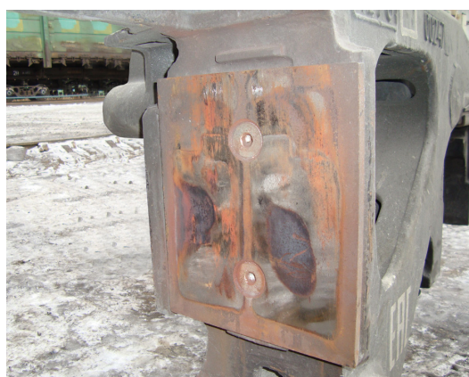
Фрикционная планка со следами приработки в зоне контакта с фрикционным клином
